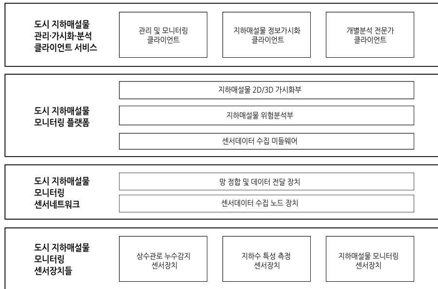
[그림 1] 도시 지하매설물 모니터링 시스템 장치 및 기능 구성도
