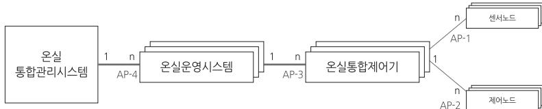
[그림 1] 온실 관제 시스템 요소 인터페이스 구조
