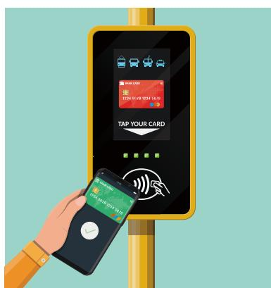
(RF)-적외선(IR) 등의 통신 방식이다. ‘전자태그(RFID)’를 응용한 것으로, 초고주파 신호를 처리하는 회로를 담고 있다. 교통카드나 택배상자 등에 주로 쓰이는 RFID가 데이터를 읽기만 하는 수동적인 기능에 머문다면 NFC는 데이터를 기록해 서로 통신을 할 수 있다는 차이점이 있다. RF·IR은 스마트폰과 단말기를 잇는 일종의 ‘인터페이스’ 역할을 하는 셈이다.
